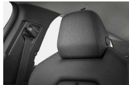
8RT Bang & Olufsen 頂級 3D 環繞音響系統 (16 揚聲器 / 830 瓦) 附雙前座四支頭枕喇叭
